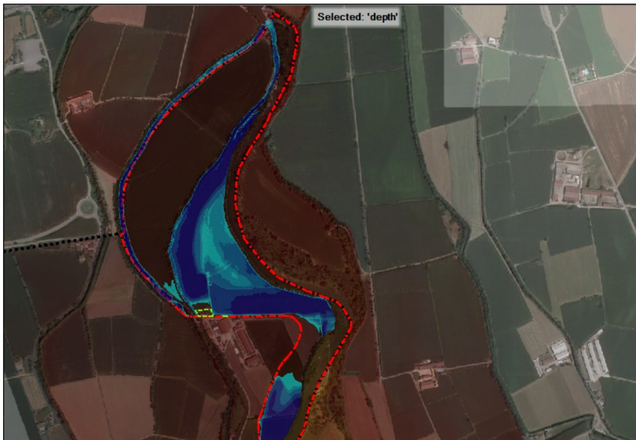
Figura n° 8.1 - Massima espansione dell'allagamento per TR 20 anni – tratto nord
