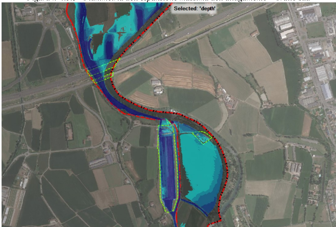
Figura n°4.5.3 - Planimetria dell'espansione massima dell'allagamento – Tratto sud
